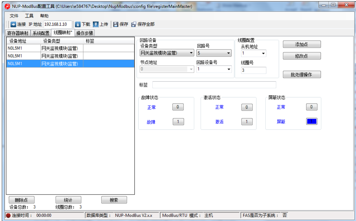
图 5-14 Modbus 线圈映射（主系统主模式）
